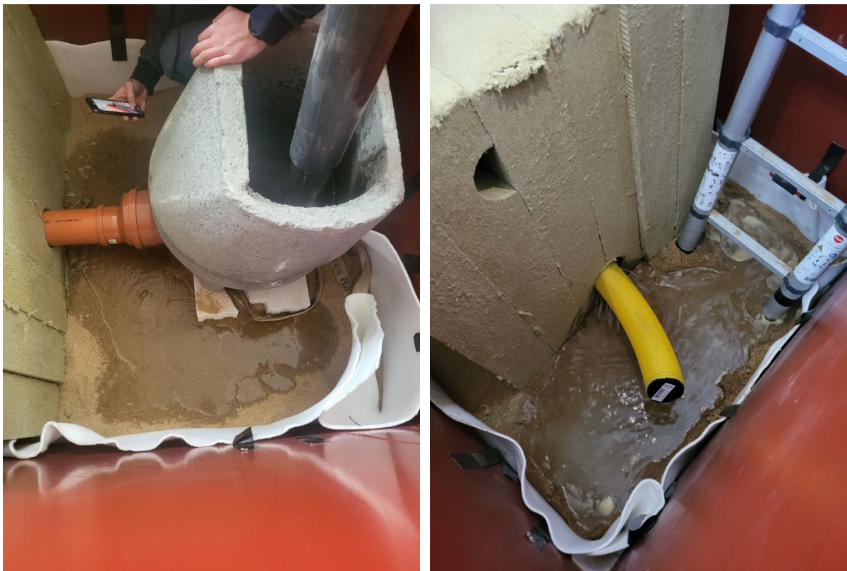
Abbildung 5-8: Einleitung des Wassers in die Rockflow-Elemente am Einlauf mit Rückstau (links) und am Ende der Elemente mit zusätzlichen Drainagerohr (rechts)
