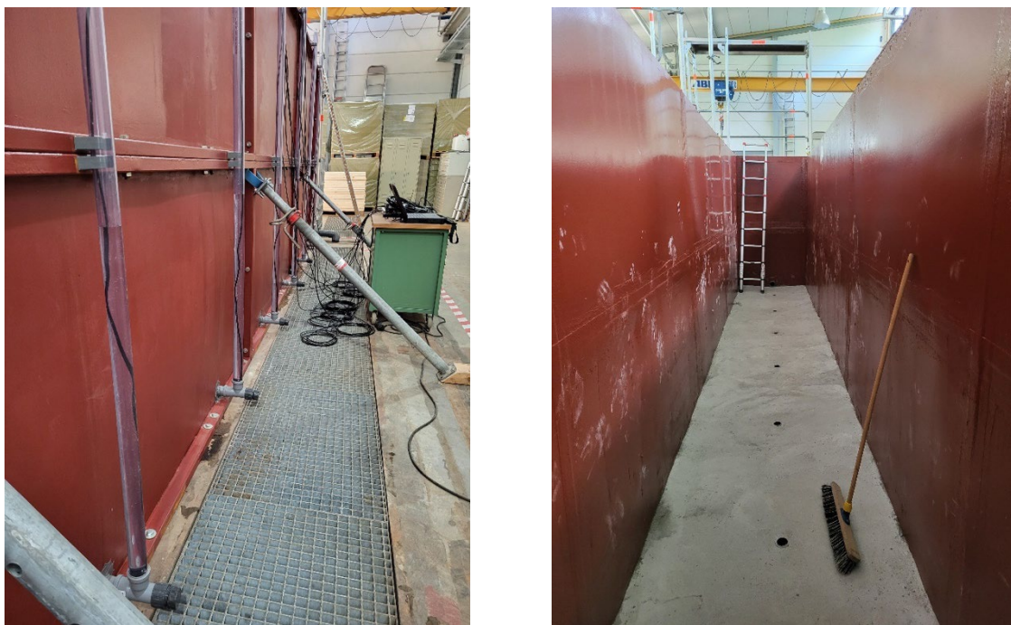
Abbildung 5-1: Seitliche Ansicht des Behälters mit der Zulaufpumpe und Rücklaufkanal (links) und Innenansicht des Versuchsbehälters (rechts)
