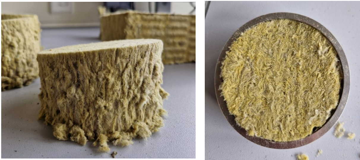
Abbildung 6-11: Fehlerquellen bei der Probeentnahme (Seitenansicht a) Draufsicht b) (eigene Darstellung)
